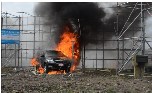
Zkoušky požáru osobního automobilu – Buštěhrad 7. 10. 2014 (DVÚ č. 4 VF20112015021)
