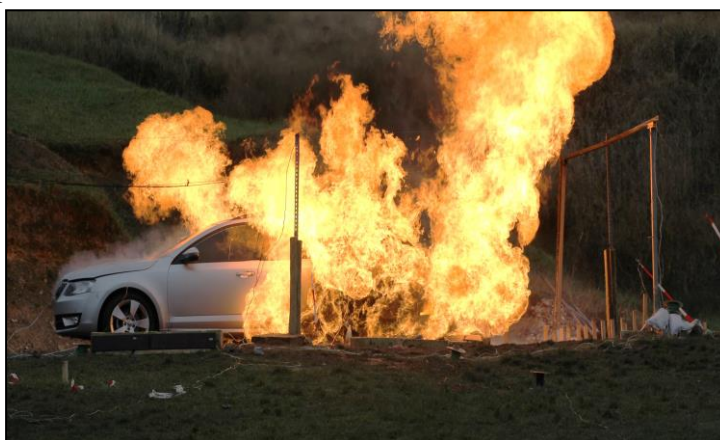
Modelová zkouška požáru automobilu Škoda Octavia s pohonem na CNG
